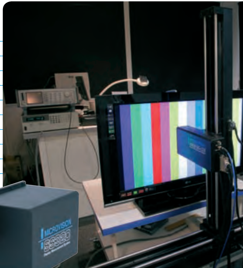
La tête « gonio » permet de mesurer l'écran sous tous les angles.
