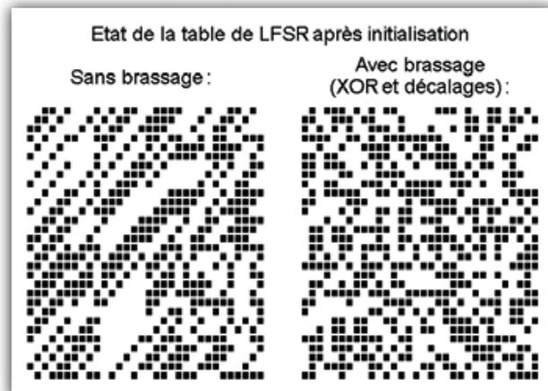
Fig 5 : Quelques décalages et XOR supplémentaires aident à gommer les petits défauts d'un LFSR.
