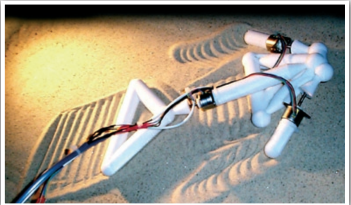
Fig. 2 : Créature dont la morphologie et le contrôleur ont été obtenus à l'aide d'une méthode évolutionniste (Projet GOLEM, par Lipson et Pollack, université de Brandeis). Les parties du corps et les circuits de contrôle sont d'abord évolués en simulation, puis une technologie de prototypage rapide est utilisée pour obtenir un robot réel.
